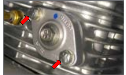
Pernos de Tensor de Cadena de Levas
