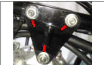
Tuerca de Soporte Superior del Motor
