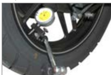
Desgaste Radial de la Rueda
