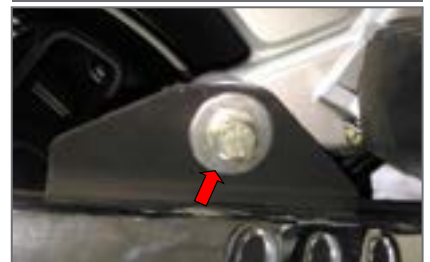
Pernos del Soporte del Silenciador
