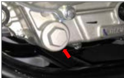
Perno de Drenaje (18 mm A/F)
