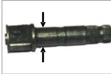
Diámetro Leva de freno delantero
