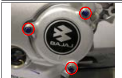
Tuerca del Filtro Centrifugo de Aceite
