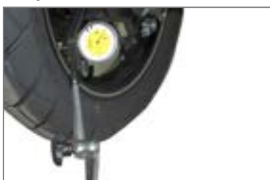
Desgaste Axial de la Rueda
