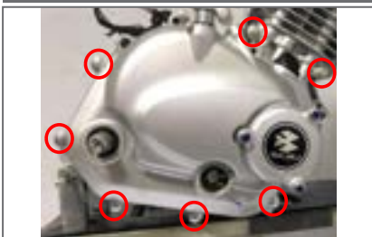
Pernos Cubierta de Embrague
