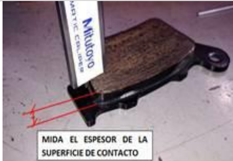
Espesor de las pastillas de freno
